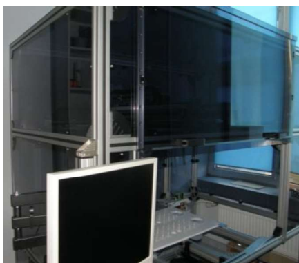
Rys. 10 Oryginalnie zaprojektowany układ do automatycznego nakładania powłok polimerowych
