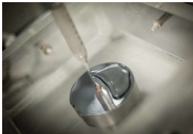
Rys. 3. Etap nakładania koncentratu czerwonych ciałek krwi na powierzchnię analizowanej próbki
