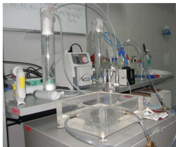
Rys. 3. Etap nakładania koncentratu czerwonych ciałek krwi na powierzchnię analizowanej próbki
