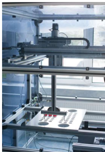
Rys. 11 Układ do nakładania powłok polimerowych- widok ramienia roboczego
